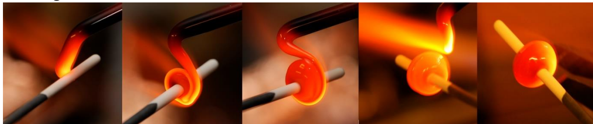
Fig. 21 Lindningstekniken, steg för steg.
