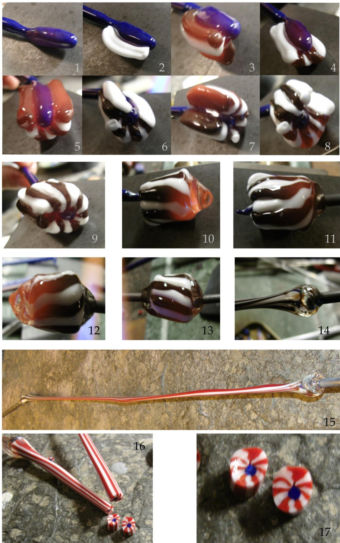
Fig. 29 Experimentell tillverkning av murrini. Foto av författaren.
